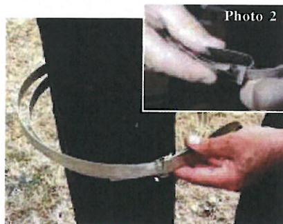
Si nécessaire, enroulez de nouveau le feuillard autour de l'objet et repassez-le dans la boucle. Ce serrage double produit une pression radiale beaucoup plus forte qu'un serrage simple. Repliez le bout de feuillard sous la boucle (photo 2).
